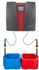
輕巧型預先安裝二氧化氯製備和定量系統。Oxiperm Pro 從稀釋的 NaClO<sub>2</sub>、HCl 和水產生 ClO<sub>2</sub> 溶液，並支援流量比例或設定點控制定量。用於安裝和測量 ClO<sub>2</sub> 含量的配件是產品範圍的一部分。最大 ClO<sub>2</sub> 製備量：60 克/小時
