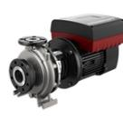
符合 ISO 2858 標準的緊密結合泵浦。法蘭為 PN 16，尺寸符合 AS2129 表 E。該泵浦配置軸向吸入口、徑向排出口、水平軸和後拉式設計，可在不干擾泵浦外殼或管道工程的情況下，拆卸馬達、馬達座、蓋子和葉輪。
