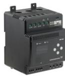
MP 204 根據電源電壓、相位序列或諧波失真等許多參數，保護馬達不受過載、乾運轉和過早發生的馬達缺陷的影響。例如，如果電流超過預設值時，會中斷接觸器。它可以獨立使用，也可以整合到控制 DC 中。
