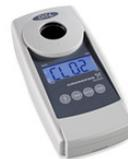
多種參數光度計 (如氯、ClO<sub>2</sub>、O<sub>3</sub>、pH 值)，使用兩種不同波長，採用優質干涉濾光片和長期穩定的 LED 作為光源，無可移動零件，自動選擇波長，操作便利。
