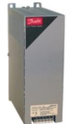
正弦波濾波器的濾波程度高，可大幅降低馬達絕緣系統的應力。同時，它們還可以降低馬達的噪音。由於正弦波濾波器將頻率轉換器的輸出脈衝轉換為正弦波狀，因此減少馬達損耗。
