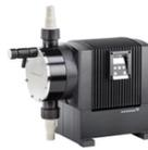
配置變速馬達驅動的數位隔膜定量泵浦。為了提高精度，可以透過簡單的校準功能，根據實際安裝情況進行泵浦校準。調節比為 1 至 800，具有相同的精度和均勻的劑量，並且在整個容量範圍內減少脈動。
