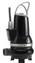
葛蘭富 EF 泵浦具有單葉片、半開式葉輪，自由通道為 30 公釐，設計用於泵浦輸送污水和其他液體，例如帶纖維和小雜質的排水和地表水。
