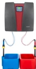
輕巧型預先安裝二氧化氯製備和定量系統。Oxiper Pro 從稀釋的 NaClO<sub>2</sub>、HCl 和水產生 ClO<sub>2</sub> 溶液，並支援流量比例或設定點控制定量。用於安裝和測量 ClO<sub>2</sub> 含量的配件是產品範圍的一部分。最大 ClO<sub>2</sub> 製備量：60 克/小時
