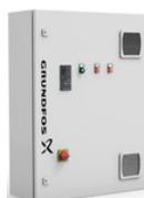
葛蘭富 Control CUE 是一系列外部變頻器，專為各種葛蘭富泵浦的速度控制而設計。頻率轉換器安裝在配置主開關、斷路器和可選濾波器的機櫃中。電源範圍：2.2 千瓦 - 90 千瓦。
