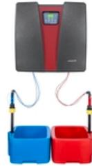
輕巧型預先安裝二氧化氯製備和定量系統。Oxiper Pro 從稀釋的  $\text{NaClO}_2$ 、 $\text{HCl}$  和水產生  $\text{ClO}_2$  溶液，並支援流量比例或設定點控制定量。用於安裝和測量  $\text{ClO}_2$  含量的配件是產品範圍的一部分。最大  $\text{ClO}_2$  製備量：60 克/小時
