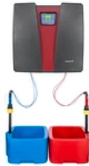
輕巧型預先安裝二氧化氯製備和定量系統。Oxiperma Pro 從稀釋的  $\text{NaClO}_2$ 、 $\text{HCl}$  和水產生  $\text{ClO}_2$  溶液，並支援流量比例或設定點控制定量。用於安裝和測量  $\text{ClO}_2$  含量的配件是產品範圍的一部分。最大  $\text{ClO}_2$  製備量：60 克/小時
