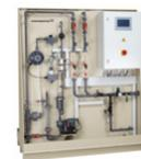
輕巧型預先安裝二氧化氯製備系統。Oxiperme 166 使用濃縮 NaClO<sub>2</sub>、氯氣和水產生 ClO<sub>2</sub> 溶液，並將其儲放在隨附的配料儲存槽中。產品範圍涵蓋化學物質容器和製程注入點間所需的所有設備。最大 ClO<sub>2</sub> 製備量：10 克/小時
