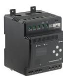
MP 204 根據電源電壓、相位序列或諧波失真等許多參數，保護馬達不受過載、乾運轉和過早發生的馬達缺陷的影響。例如，如果電流超過預設值時，會中斷接觸器。它可以獨立使用，也可以整合到控制 DC 中。
