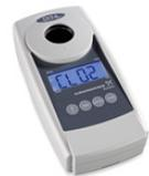
多種參數光度計 ( 如氯、ClO<sub>2</sub>、O<sub>3</sub>、pH 值 )，使用兩種不同波長，採用優質干涉濾光片和長期穩定的 LED 作為光源，無可移動零件，自動選擇波長，操作便利。
