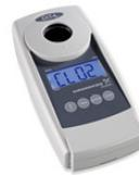
多種參數光度計 (如氯、ClO<sub>2</sub>、O<sub>3</sub>、pH 值)，使用兩種不同波長，採用優質干涉濾光片和長期穩定的 LED 作為光源，無可移動零件，自動選擇波長，操作便利。
