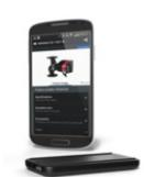
葛蘭富遠距遙控器用於透過無線電或紅外連接，進行葛蘭富泵浦和系統的安裝、資料監測、故障資訊和配置。
