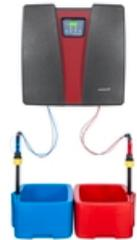
輕巧型預先安裝二氧化氯製備和定量系統。Oxiperme Pro 從稀釋的 NaClO<sub>2</sub>、HCl 和水產生 ClO<sub>2</sub> 溶液，並支援流量比例或設定點控制定量。用於安裝和測量 ClO<sub>2</sub> 含量的配件是產品範圍的一部分。最大 ClO<sub>2</sub> 製備量：60 克/小時
