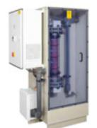
SES 電解系統利用電力，從食鹽和水中產生次氯酸鈉溶液。配件系列提供從鹽水製備到注入點的完整安裝。最大產生量最高達 1.8 公斤/小時 (SES 125-2000) 和 45 公斤/小時 (SES 5000-45000) 氯當量。
