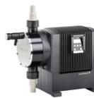
配置變速馬達驅動的數位隔膜定量泵浦。為了提高精度，可以透過簡單的校準功能，根據實際安裝情況進行泵浦校準。調節比為 1 至 800，具有相同的精度和均勻的劑量，並且在整個容量範圍內減少脈動。
