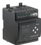
MP 204 根據電源電壓、相位序列或諧波失真等許多參數，保護馬達不受過載、乾運轉和過早發生的馬達缺陷的影響。例如，如果電流超過預設值時，會中斷接觸器。它可以獨立使用，也可以整合到控制 DC 中。
