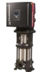
La gamme iSolutions Q-pump se compose de pompes haute pression CRNE, spécialement conçues pour une utilisation maximale du moteur MGE dans les applications haute pression. La partie hydraulique a une pile inversée et des chambres renforcées. Elle est optimisée pour une meilleure performance Q/H avec des vitesses maximales plus élevées.
