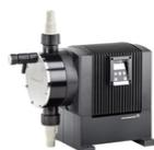
Pompe doseuse numérique à membrane avec moteur à vitesse variable. Pour une précision accrue, la pompe peut être calibrée en fonction de l'installation réelle au moyen d'un étalonnage simple. La marge de réglage est de 1 à 800 avec la même précision et un dosage uniforme avec une pulsation réduite sur toute la plage de capacité.
