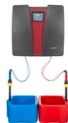
Système compact de préparation et de dosage de dioxyde de chlore prémonté. OxipermPro produit une solution de ClO<sub>2</sub> à partir de NaClO<sub>2</sub> dilué, de HCl et d'eau et permet un dosage proportionnel au débit ou contrôlé par un point de consigne. Les accessoires pour l'installation et la mesure de la teneur en ClO<sub>2</sub> font partie de cette gamme de produits. Qté max. de prép. de ClO<sub>2</sub>: 60g/h
