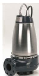
Les pompes de relevage immergées Grundfos SE sont équipées d'une roue S-tube® (SE1) ou SuperVortex (SEV). La section de passage à travers la pompe varie de 50 à 100mm en fonction de la taille.
