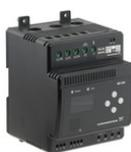
Le MP204 protège le moteur contre la surcharge, le fonctionnement à sec et les défauts initiaux du moteur en fonction de nombreux paramètres tels que la tension d'alimentation, la séquence de phase ou la distorsion harmonique. Il déconnecte le contacteur si, par exemple, le courant dépasse la valeur prédéfinie. Il peut être utilisé de manière autonome ou incorporé dans un Control DC par exemple.
