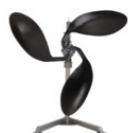
La gamme d'accélérateurs de courant horizontaux à engrenages planétaires AFG Grundfos est conçue pour accélérer l'écoulement, c'est-à-dire favoriser la circulation des liquides à faible/moyenne viscosité. Avec moteurs de 1,5 à 7,5kW.
