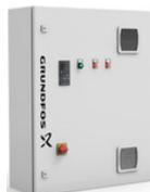
Grundfos Control CUE est une gamme complète de convertisseurs de fréquence externes conçus pour la régulation de vitesse d'un grand nombre de pompes Grundfos. Le convertisseur de fréquence est livré installé dans un coffret avec un interrupteur principal, un disjoncteur et un filtre en option. Plage de puissance: 2,2 à 90kW
