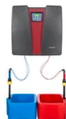
Système compact de préparation et de dosage de dioxyde de chlore prémonté. OxipermPro produit une solution de ClO<sub>2</sub> à partir de NaClO<sub>2</sub> dilué, de HCl et d'eau et permet un dosage proportionnel au débit ou contrôlé par un point de consigne. Les accessoires pour l'installation et la mesure de la teneur en ClO<sub>2</sub> font partie de cette gamme de produits.
