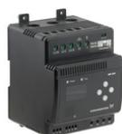
Le MP204 protège le moteur contre la surcharge, le fonctionnement à sec et les défauts initiaux du moteur en fonction de nombreux paramètres tels que la tension d'alimentation, la séquence de phase ou la distorsion harmonique. Il déconnecte le contacteur si, par exemple, le courant dépasse la valeur prédéfinie. Il peut être utilisé de manière autonome ou incorporé dans un Control DC par exemple.
