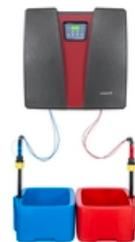
Système compact de préparation et de dosage de dioxyde de chlore prémonté. OxipermPro produit une solution de  $\text{ClO}_2$  à partir de  $\text{NaClO}_2$  dilué, de  $\text{HCl}$  et d'eau et permet un dosage proportionnel au débit ou contrôlé par un point de consigne. Les accessoires pour l'installation et la mesure de la teneur en  $\text{ClO}_2$  font partie de cette gamme de produits. Qté max. de prép. de  $\text{ClO}_2$ : 60g/h
