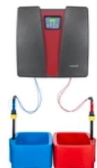
Système compact de préparation et de dosage de dioxyde de chlore prémonté. OxipermPro produit une solution de ClO<sub>2</sub> à partir de NaClO<sub>2</sub> dilué, de HCl et d'eau et permet un dosage proportionnel au débit ou contrôlé par un point de consigne. Les accessoires pour l'installation et la mesure de la teneur en ClO<sub>2</sub> font partie de cette gamme de produits.
