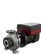
Pompes à aspiration axiale monobloc normalisées selon norme EN2858. Les brides sont des PN16 avec des dimensions conformes au tableau E - AS2129. La pompe possède un orifice d'aspiration axial, un orifice de refoulement radial, un arbre horizontal et une partie arrière amovible permettant de retirer le moteur, la lanterne, le flasque et la roue sans démonter le corps de pompe ni la tuyauterie.
