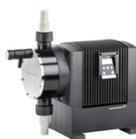
Pompe doseuse numérique à membrane avec moteur à vitesse variable. Pour une précision accrue, la pompe peut être calibrée en fonction de l'installation réelle au moyen d'un étalonnage simple. La marge de réglage est de 1 à 800 avec la même précision et un dosage uniforme avec une pulsation réduite sur toute la plage de capacité.
