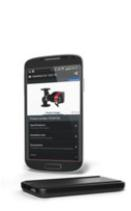
Controles remotosGrundfos empleados para la instalación, monitorización de datos, notificación de fallos y configuración de bombas y sistemas Grundfos mediante comunicación por radio oIR.
