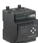
La unidad MP204 protege el motor contra la sobrecarga, la marcha en seco y los defectos incipientes del motor basándose en muchos parámetros como la tensión de alimentación, la secuencia de fases o la distorsión armónica. Desconecta el contactor si, por ejemplo, la corriente supera el valor preestablecido. Puede usarse de manera independiente o integrado en un sistema Control DC.
