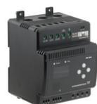
La unidad MP204 protege el motor contra la sobrecarga, la marcha en seco y los defectos incipientes del motor basándose en muchos parámetros como la tensión de alimentación, la secuencia de fases o la distorsión armónica. Desconecta el contactor si, por ejemplo, la corriente supera el valor preestablecido. Puede usarse de manera independiente o integrado en un sistema ControlDC.
