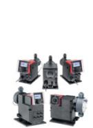
Bomba dosificadora de membrana SMART Digital con potente motor paso a paso de velocidad variable (S) o potente motor PMS (motor síncrono de imanes permanentes) (XL) y sistema FlowControl para detectar las averías de forma automática. Solución de alta gama para aplicaciones complejas y exigentes con relación entre los valores extremos de caudal de hasta 1:3000.
