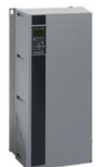
La gamaCUE se compone de variadores de frecuencia externos diseñados para controlar la velocidad de una amplia variedad de bombas Grundfos. La gamaCUE incorpora un controladorPI y ofrece las mismas funcionalidades e interfaz de usuario que las bombasE de Grundfos. Rango de potencia hasta 250kW.
