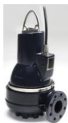
Las bombas sumergibles Grundfos SLV de aguas negras están equipadas con un impulsor SuperVortex. El paso libre a través de la bomba varía entre 50 y 100mm en función de las dimensiones.
