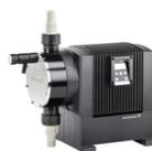
Bomba dosificadora digital de membrana con accionamiento por motor de velocidad variable. Para aumentar la precisión, la bomba puede calibrarse según la instalación real mediante una sencilla función de calibración. La relación entre los valores extremos de caudal es de 1:800 con la misma precisión y dosificación uniforme con pulsación reducida en todo el rango de capacidad.
