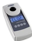
Fotómetros para varios parámetros (por ejemplo, cloro, ClO<sub>2</sub>, O<sub>3</sub>, pH), con dos longitudes de onda diferentes, con filtros de interferencia de alta calidad y fuente de luz LED estables a largo plazo, sin piezas móviles, con selección automática de la longitud de onda y fáciles de manejar.
