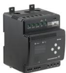
La unidad MP204 protege el motor contra la sobrecarga, la marcha en seco y los defectos incipientes del motor basándose en muchos parámetros como la tensión de alimentación, la secuencia de fases o la distorsión armónica. Desconecta el contactor si, por ejemplo, la corriente supera el valor preestablecido. Puede usarse de manera independiente o integrado en un sistema Control DC.
