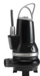
Las bombasGrundfosEF están equipadas con un impulsor semiabierto de un solo álabe para permitir un paso libre de 30mm, y están diseñadas para el bombeo de efluentes y otros líquidos como las aguas de achique y de superficie con fibras e impurezas pequeñas.
