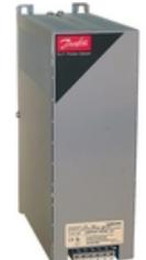
Los filtros sinusoidales tienen un alto grado de filtrado, lo que se traduce en una gran reducción de la tensión en el sistema de aislamiento del motor. Al mismo tiempo, reducen el ruido acústico del motor. Las pérdidas del motor se reducen debido a que un filtro sinusoidal convierte los impulsos de salida del variador de frecuencia en una onda sinusoidal.
