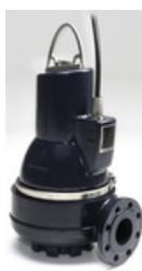
Las bombas sumergibles GrundfosSLV de aguas negras están equipadas con un impulsorSuperVortex. El paso libre a través de la bomba varía entre50 y 100mm en función de las dimensiones.
