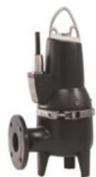
Las bombas sumergibles GrundfosSL de aguas negras están equipadas con un impulsor S-tube®. El paso libre a través de la bomba varía entre50 y 100mm en función de las dimensiones.
