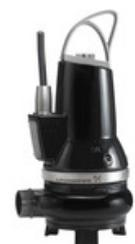
Las bombas Grundfos EF están equipadas con un impulsor semiabierto de un solo álabe para permitir un paso libre de 30mm, y están diseñadas para el bombeo de efluentes y otros líquidos como las aguas de achique y de superficie con fibras e impurezas pequeñas.
