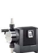
Bomba dosificadora digital de membrana con accionamiento por motor de velocidad variable. Para aumentar la precisión, la bomba puede calibrarse según la instalación real mediante una sencilla función de calibración. La relación entre los valores extremos de caudal es de1:800 con la misma precisión y dosificación uniforme con pulsación reducida en todo el rango de capacidad.
