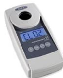
Fotómetros para varios parámetros (por ejemplo, cloro, ClO<sub>2</sub>, O<sub>3</sub>, pH), con dos longitudes de onda diferentes, con filtros de interferencia de alta calidad y fuente de luz LED estables a largo plazo, sin piezas móviles, con selección automática de la longitud de onda y fáciles de manejar.
