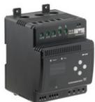
MP 204 schützt den Motor anhand verschiedenster Parameter wie Versorgungsspannung, Phasenfolge oder harmonischer Verzerrung vor Überlast, Trockenlauf und beginnenden Motordefekten. Es trennt das Schütz, wenn beispielsweise der Strom den voreingestellten Wert überschreitet. Es kann eigenständig eingesetzt oder beispielsweise in eine Control DC integriert werden.
