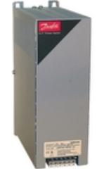
Sinusfilter haben einen hohen Filtergrad, wodurch die Belastung des Motorisolationssystems erheblich reduziert werden kann. Gleichzeitig reduzieren sie die akustischen Geräusche des Motors. Die Motorverluste werden dadurch reduziert, dass ein Sinusfilter die Ausgangsimpulse des Frequenzumrichters in eine Sinusform umwandelt.
