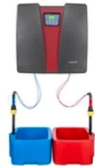
Kompakte, vormontierte Anlage zum Erzeugen und Dosieren von Chlordioxid. Oxiperm Pro erzeugt eine ClO<sub>2</sub>-Lösung aus verdünntem ClO<sub>2</sub>, HCl und Wasser. Die Anlage unterstützt die durchflussproportionale oder sollwertgeregelte Dosierung. Zubehör zur Installation und Messung des ClO<sub>2</sub>-Gehalts ist Teil des Produktangebots. Max. erzeugte ClO<sub>2</sub>-Menge: 60g/h
