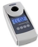
Photometer für mehrere Parameter (z. B. Chlor, ClO<sub>2</sub>, O<sub>3</sub>, pH) mit zwei verschiedenen Wellenlängen sowie hochwertigen Interferenzfiltern und langzeitstabilen LEDs als Lichtquelle, ohne bewegliche Teile, automatische Auswahl der Wellenlänge, einfache Bedienung.
