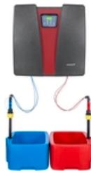
Kompakte, vormontierte Anlage zum Erzeugen und Dosieren von Chlordioxid. Oxiperm Pro erzeugt eine ClO<sub>2</sub>-Lösung aus verdünntem ClO<sub>2</sub>, HCl und Wasser. Die Anlage unterstützt die durchflussproportionale oder sollwertgeregelte Dosierung. Zubehör zur Installation und Messung des ClO<sub>2</sub>-Gehalts ist Teil des Produktangebots. Max. erzeugte ClO<sub>2</sub>-Menge: 60g/h
