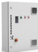
Grundfos Control CUE ist eine Baureihe externer Frequenzumrichter, die für die Drehzahlregelung verschiedenster Pumpen von Grundfos entwickelt wurde. Der Frequenzumrichter wird in einem Schaltschrank mit Hauptschalter, Leistungsschalter und optionalem Filter geliefert. Leistungsbereich: 2,2–90 kW.
