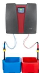
Kompakte, vormontierte Anlage zum Erzeugen und Dosieren von Chlordioxid. Oxiperm Pro erzeugt eine ClO<sub>2</sub>-Lösung aus verdünntem ClO<sub>2</sub>, HCl und Wasser. Die Anlage unterstützt die durchflussproportionale oder sollwertgeregelte Dosierung. Zubehör zur Installation und Messung des ClO<sub>2</sub>-Gehalts ist Teil des Produktangebots. Max. erzeugte ClO<sub>2</sub>-Menge: 60g/h
