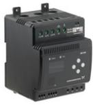
MP 204 schützt den Motor anhand verschiedenster Parameter wie Versorgungsspannung, Phasenfolge oder harmonischer Verzerrung vor Überlast, Trockenlauf und beginnenden Motordefekten. Es trennt das Schütz, wenn beispielsweise der Strom den voreingestellten Wert überschreitet. Es kann eigenständig eingesetzt oder beispielsweise in eine Control DC integriert werden.
