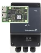
Kommunikationsschnittstellen bietet Grundfos unter der Bezeichnung CIM bzw. CIU (Communication Interface Module/Communication Interface Unit, also Kommunikationsschnittstellenmodul bzw. -gerät) an. Damit können Sie Ihr Produkt an die unterschiedlichsten Feldbusstandards anbinden.
