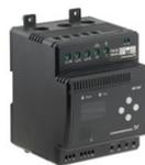
MP 204 schützt den Motor anhand verschiedenster Parameter wie Versorgungsspannung, Phasenfolge oder harmonischer Verzerrung vor Überlast, Trockenlauf und beginnenden Motordefekten. Es trennt das Schütz, wenn beispielsweise der Strom den voreingestellten Wert überschreitet. Es kann eigenständig eingesetzt oder beispielsweise in eine Control DC integriert werden.
