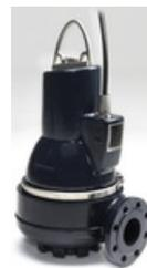
Grundfos SLV-Abwassertauchpumpen sind mit einem SuperVortex-Laufrad ausgestattet. Der freie Durchgang durch die Pumpe variiert je nach Größe zwischen 50 und 100 mm.
