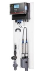
Das DID-System mit Bypass Durchflussmesszelle ist auf die Überwachung und Anpassung von Desinfektionsmitteln, pH-Wert, Redox-Spannung, Leitfähigkeit und Temperatur ausgelegt. Das System ist auf einer gemeinsamen Grundplatte vormontiert und beinhaltet eine Steuereinheit CU382 sowie einen oder mehrere Wasserparametersensoren. Mehrere Zubehörteile sind erhältlich.
