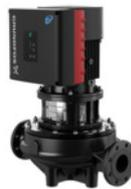
Grundfos TP-/TPE-Pumpen sind einstufige Inline-Kreiselpumpen in Blockbauweise mit Gleitringdichtung, primär geeignet für Anwendungen wie Heizung, Kühlung und Fernwärme. Bei TPD-/TPDE-Pumpen handelt es sich um Doppelpumpen.
